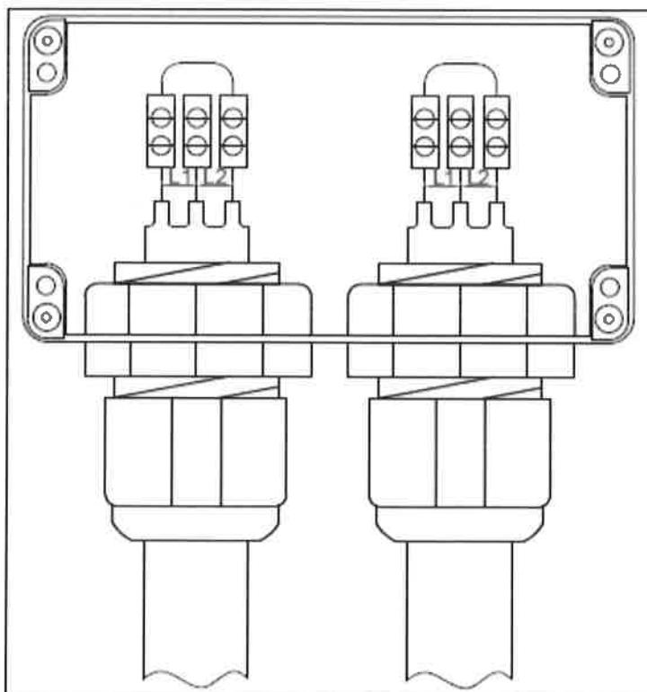
Предназначен для закольцовки сигнальных проводников.
