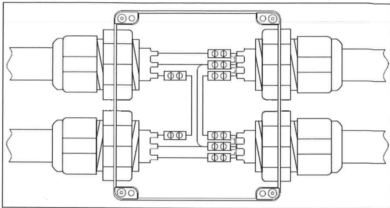
Предназначен для объединения сигнальных проводников четырех контролируемых участков трубопроводов.
