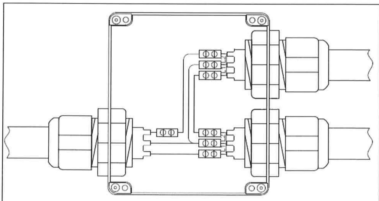
Предназначен для объединения сигнальных проводников трех контролируемых участков трубопроводов.
