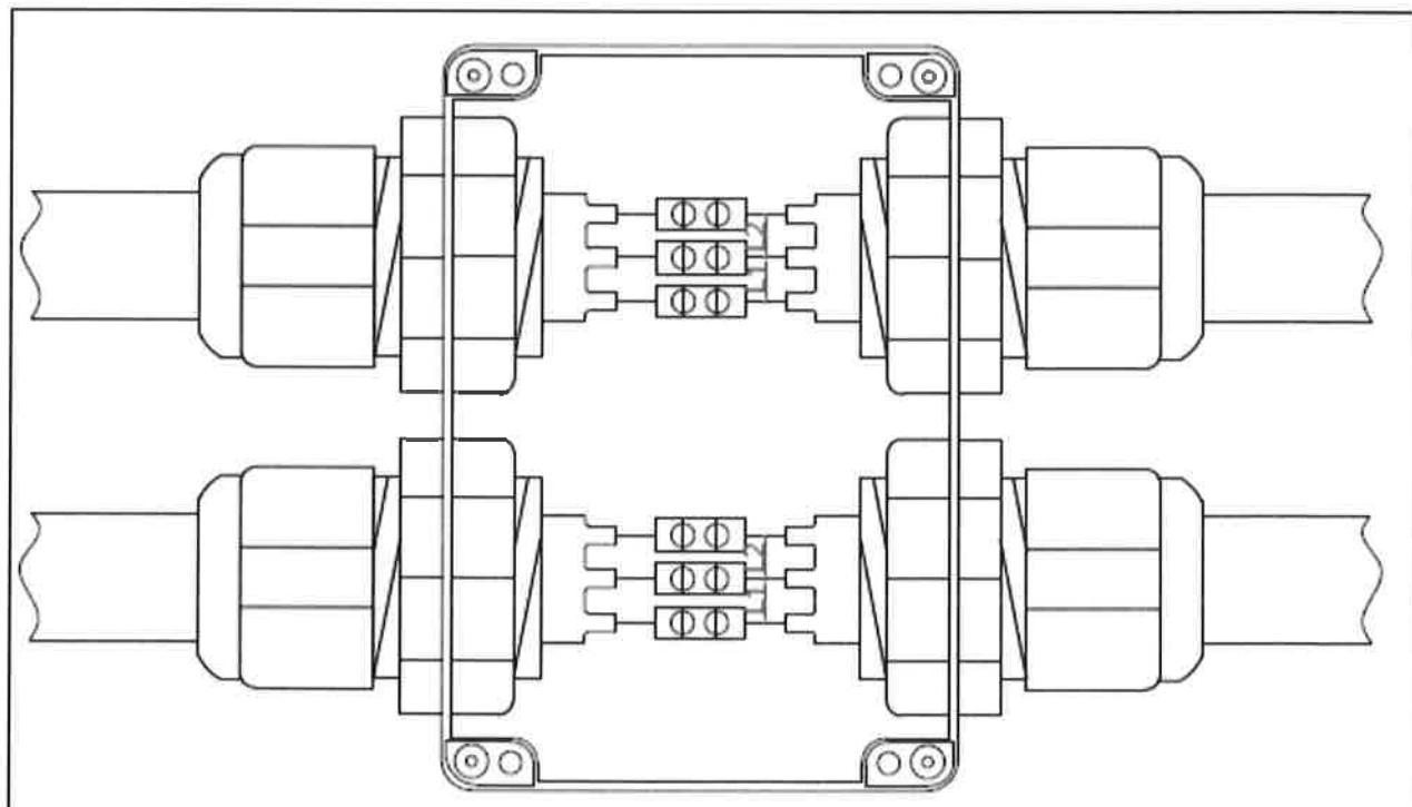
Предназначен для соединения сигнальных проводников двух контролируемых участков трубопроводов.
