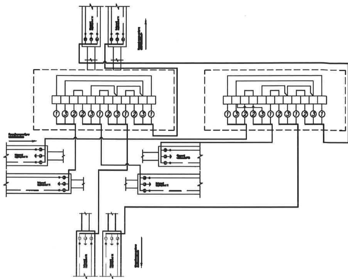
Терминал устанавливается в контрольных точках, предусмотренных проектом. Соединительный кабель СОДК-П от подающего и обратного трубопровода заводятся в разные коммутационные коробки. Таким образом, в точке контроля будет использовано два объединяющих терминала.
